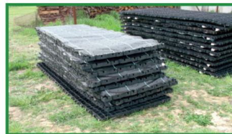
Modules de 2.7m 2 avec flotteur et géotextile
